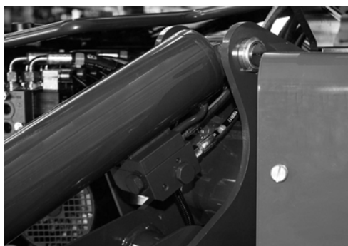
Fig. 10 Afbryderventil i sikkerhedsstiver
