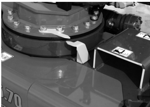
Fig. 90 Pile til kontrol af nivellering
